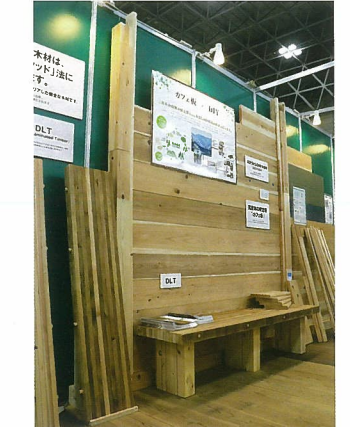
▲中国木材(株)：(株)長谷萬もくラボ事業部と共同出展。カフェ板やDLT、45mm角木材を専用クランプ(下)で簡単に仮設駆体を組み立てられる「つな木」をPR。DLTは石川県の仮設住宅で採用され、認知度が徐々に上がっている
