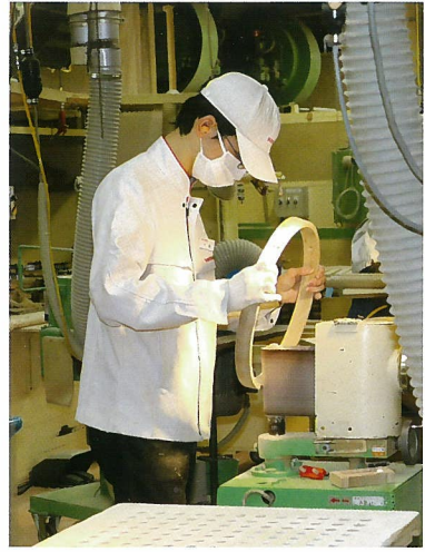
▲NC加工機の稼働と同時進行で木地調整を行なっていく
