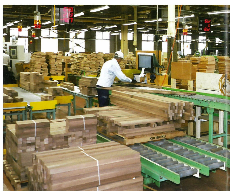
▲ジャンピングカットソーで木取りを行なうラインは5つ。人の目で最適な木取り方を選別しながら歩留まりを上げていく
