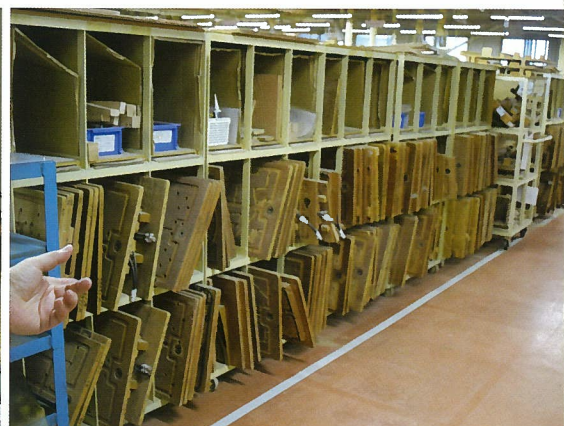
▲製品毎にセット替える2-ATCの治具は数も豊富
