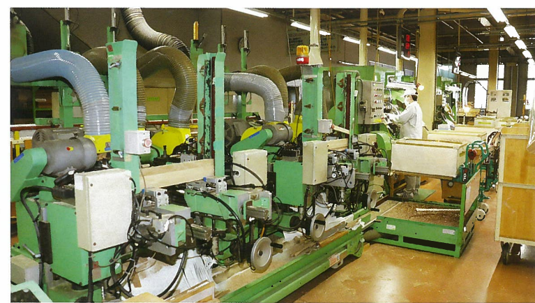
▲自動旋盤で木管を製造加工し、表面仕上げは人の手で丁寧にペーパー掛けされる
