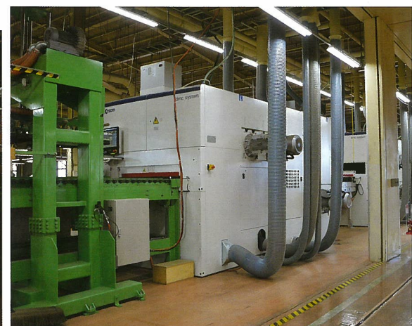
▲SCM 社製 DMC system。手前が粗削り、奥が仕上げ用でライン化されているサンダー
