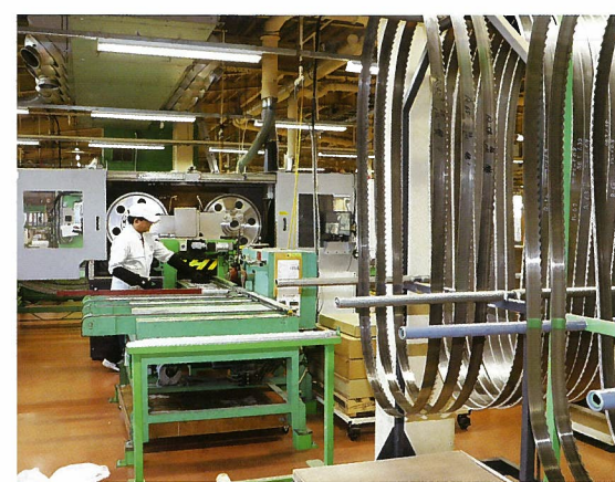
▲DKSH 扱いのフィル社製横バンドソーで厚み方向に板を挽く
