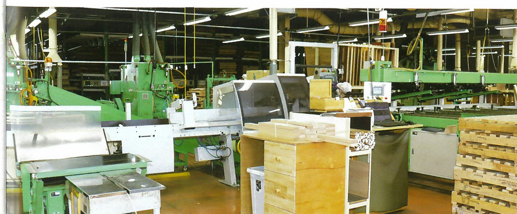
▲ヴァイニチ製オプティカットは幅カットから長さカットの際に使用している
