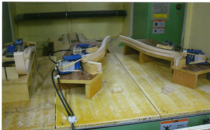
▲2-ATCは治具を使って3次元加工を行なう
