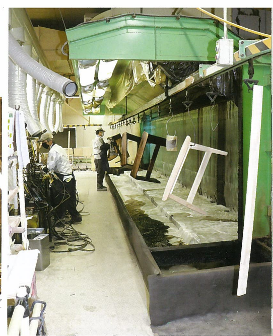
▲塗料の塗着効率は3割程で、逃げた塗料を水中に中和させて回収し、就労環境配慮に
