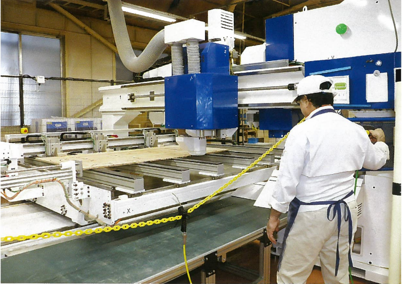
▲BACCIのMASTER CUTで木枠をネスティング
