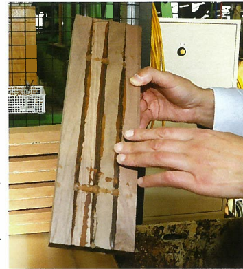
▲接着剤が通常は白いのに対し、これは接着剤を木材の色に似通わしているため、接着層が自然な仕上がりに
