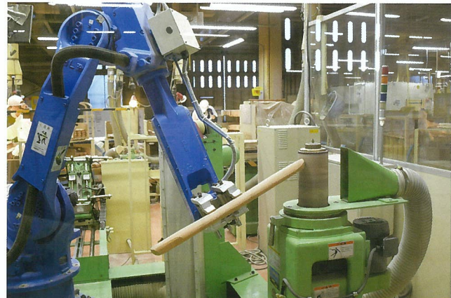
▲ロット数の多い製品の一部の部品の荒研磨はロボット研磨を活用している
