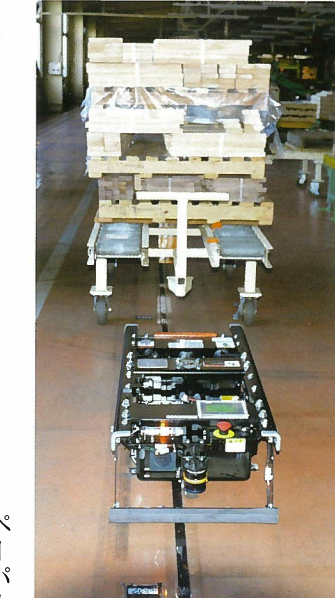
▲工場内の台車はAGV ロボットが運んでくれる
