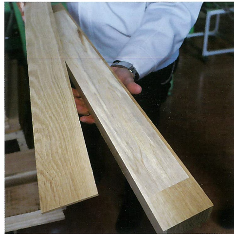
▲中にラバートリーを使い、外に針葉樹オークを使って いる。同様の接着方法で針葉樹材でも強度を担保できる。
