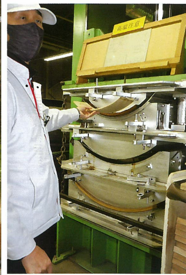
▲東洋油圧工業の曲面ホットプレスでチェアなどに使う曲木部材を加工生産する
