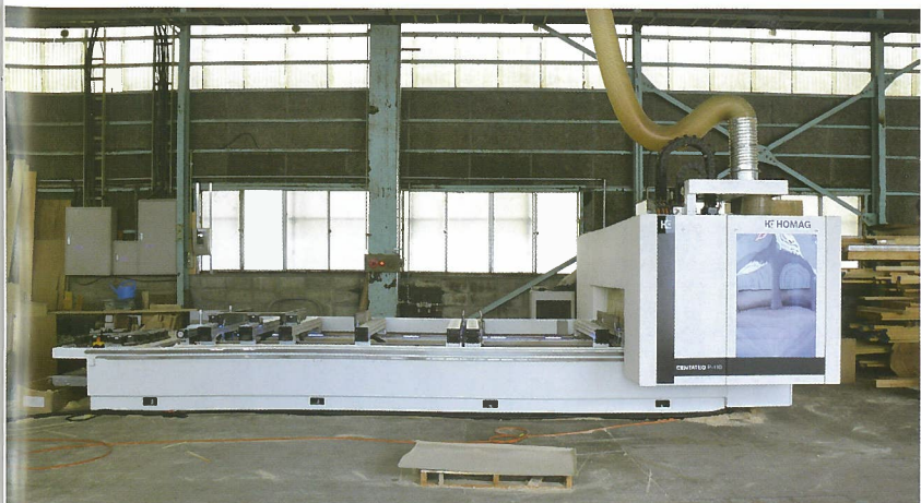
▲昨年増設したホマッグ製5軸CNC加工機 CENTATEQ P-110
