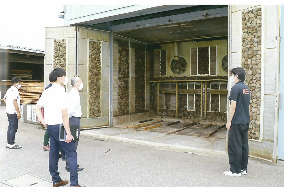
▲高速木材乾燥システム「woodbe」導入の乾燥機
