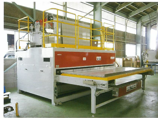
▲8月に最新導入した高周波集成材接着機 PANEX-15L型（山本ビニター）
